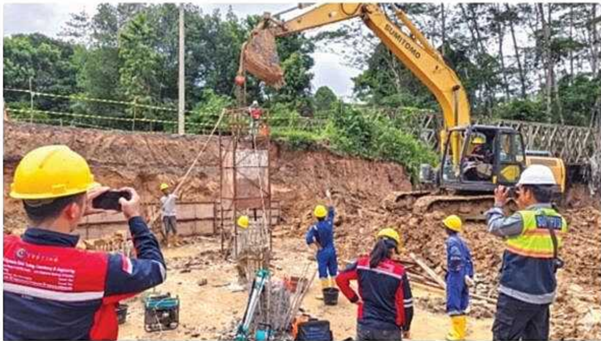
UJI MUTU FONDASI. Tim teknis melakukan pengujian kualitas bore pile pada proyek pembangunan Jembatan 1 ruas Teringa Long Bagun 8 di Kelian Dalam, Kutai Barat. Pengujian menjadi tahapan penting sebelum pekerjaan dilanjutkan ke struktur atas.
